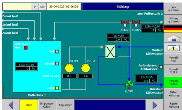
Trois installations présentes sur le même site possèdent des HMI très différents les uns des autres. Ces installations sont l'installation de neutralisation de l'usine, un autoclave et le Building Management System. Les HMI sont programmés à l'aide de TIA Portal V16 pour les deux premières installations et la dernière est programmée à l'aide de Desigo CC.
